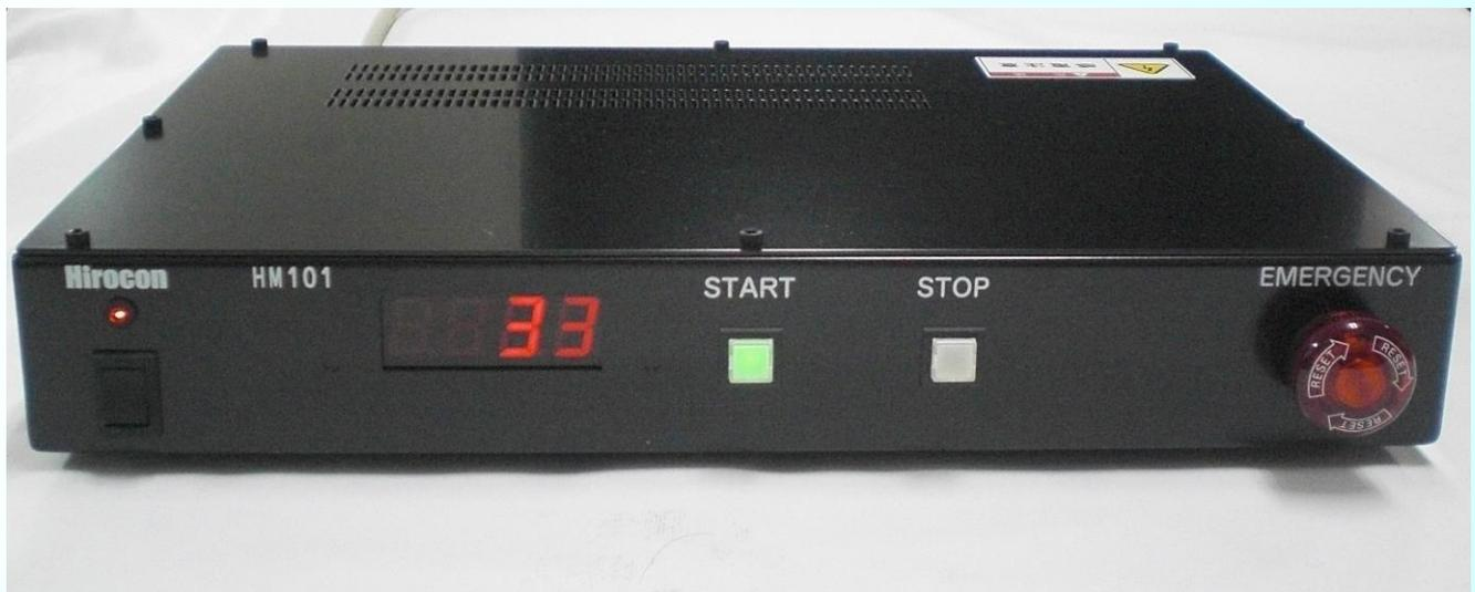
塗膜耐食性短期評価装置は、マツダ株式会社様、国立大学法人広島大学様が共同研究で完成された「耐食性迅速評価法」を用いて耐食性の評価を行う装置です。
